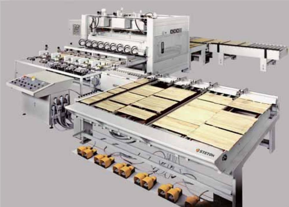
Versione con bancale di scelta della venatura e composizione pannelli al carico (anche di dimensioni e larghezze dei listelli diverse) e con sistema di scarico e smistamento pannelli pressati.
