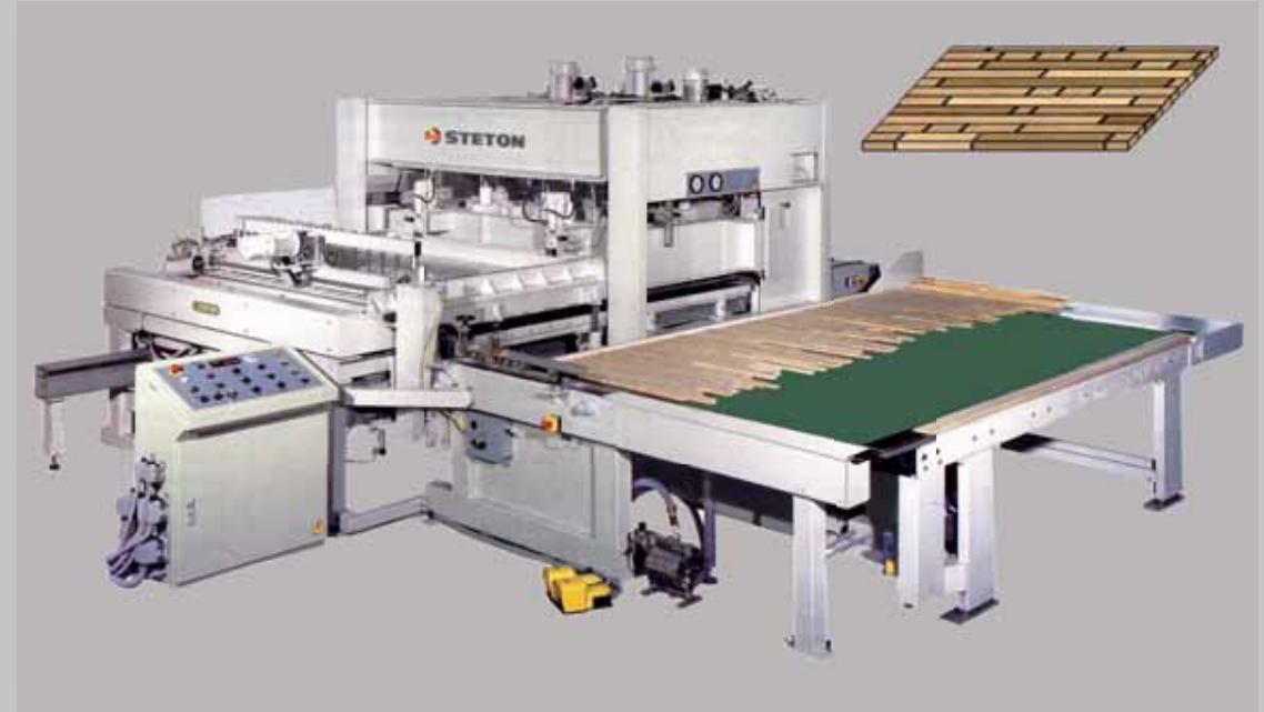
La versione "Regina" con troncatrice in linea, piano superiore di guida all'introduzione in presa, pressori laterali longitudinali e trasversali, consente la produzione di pannelli composti da listelli di lunghezza diversa, anche spezzoni di scarto (min. 50 mm), per uno sfruttamento completo del materiale.
